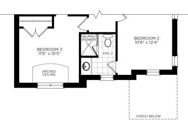
PARTIAL UPPER FLOOR PLAN ELEVATION B
